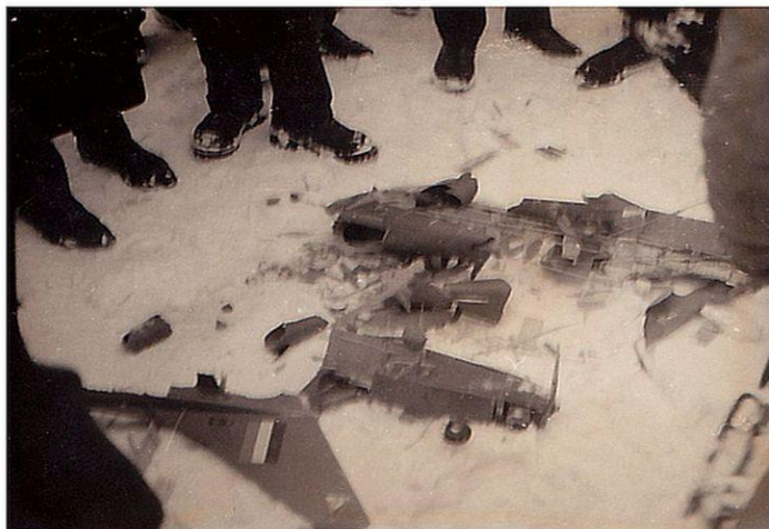
Konec obdivovaného éra byl neslavný - když za vodorovného letu prasklo jedno lanko...
