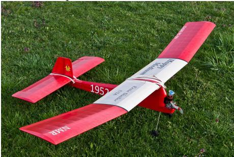
dává při hmotnosti 705 g slušné plošné zatížení 27,35 g/dm<sup>2</sup>. Poháněn je motorem MVVS 2,5 R z roku 1958. Po zalétání a 1. soutěži 11.4. v Praze – Lipencích (3. místo v kat. Nostalgie 60) bylo nutné využít příhradovinu trupu, neboť i přes opatrnu pilotáž v motorovém letu se trup kroutil až natolik, že popraskal potah. Také bylo třeba vyosit motor ještě více směrem dolů.“ Díky! A co Vy ... ?
