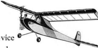
serverech, případně jej najdete na klubových stránkách SAM 95 Bohemia. Stavebně to je nenáročný model. Trup je se skládá ze dvou bočnic a je doplněný vnitřními přepážkami. Dvoukolový podvozek je ohnut z drátu o průměru 2 mm. Křídlo je jednoduché konstrukce se vzepětím
