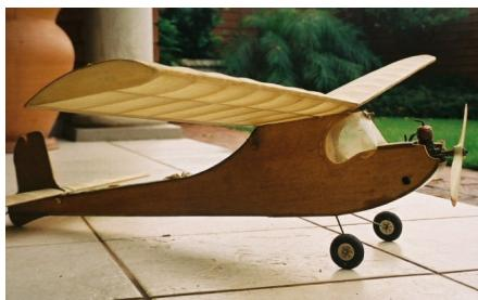
V popisu inzerátu se dále dočteme, že CARDINAL je malý model s výkony srovnatelnými se soutěžními motorovými modely. Model má jednoduchou konstrukci a byl dodáván jako stavebnice s přechytanými vyřezanými díly, vyřezanými žebry a ostatním drobným materiálem, včetně plánu s popisem práce krok za krokem.
