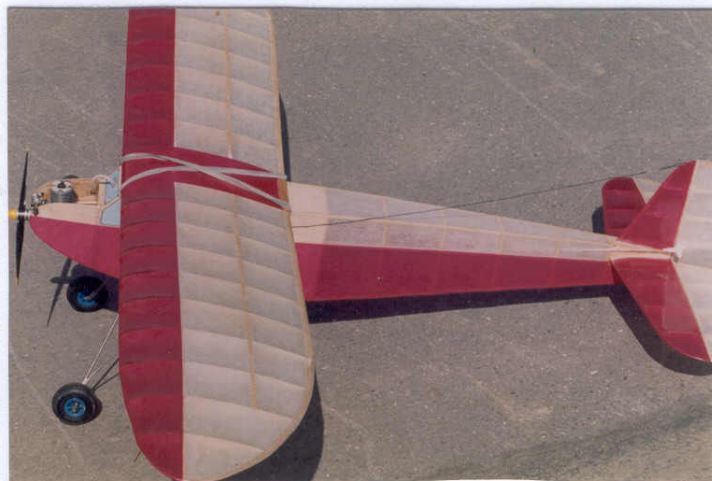
Vítězný model OSTŘÍŽ Jiřího Plačka. Model je konstrukcí dvojice Vyskočil Bušek z roku 1941. Replika je poháněna motorem MVVS 3,5 ccm. S tímto motorem je model schopen aerovleku.
