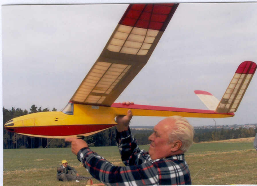
František Dvořák připravuje k vypuštění model ŠIRCHÁN konstrukce Zdeňka Formánka z roku 1949. Replika je z původního rozpětí 3.600 mm zmenšena na 2.850 mm. Křídlo je třídílné. Střed křídla je opatřen vztlakovými klapkami. Hmotnost modelu je 1.350 g. RC vybavení: přijímač REX 7, klapky serva Hitec, kormidla serva Graupner C 261 zabudovaná přímo v kormidlech, baterie NiCd 900 mAh. Vysílač Graupner 16/20 mixuje motýlkové ocasní plochy a vztlakové klapky s výškovkou.
