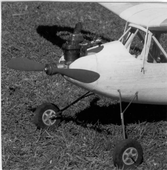
Zástavba čtyřtáhního motoru do přídě modelu COMMODORE jak ji realizoval Bare Bones
