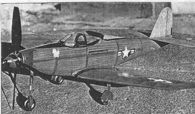
Frant. Výskala z Valašského Meziříčí poslal do redakce hezkou červenou Bell p-63 Kingcobru. Je v rozdělaném stavu, chybí dodělat znaky. Stejnou postavil i Zdeněk Raška z Frenštátu, ale ta je trochu lehčí. Data: rozpětí 585 mm, délka 495 mm, celková plocha 7,33 dm 2 , hmotnost 38 g, zatížení 5,25 g/dm 2 .
