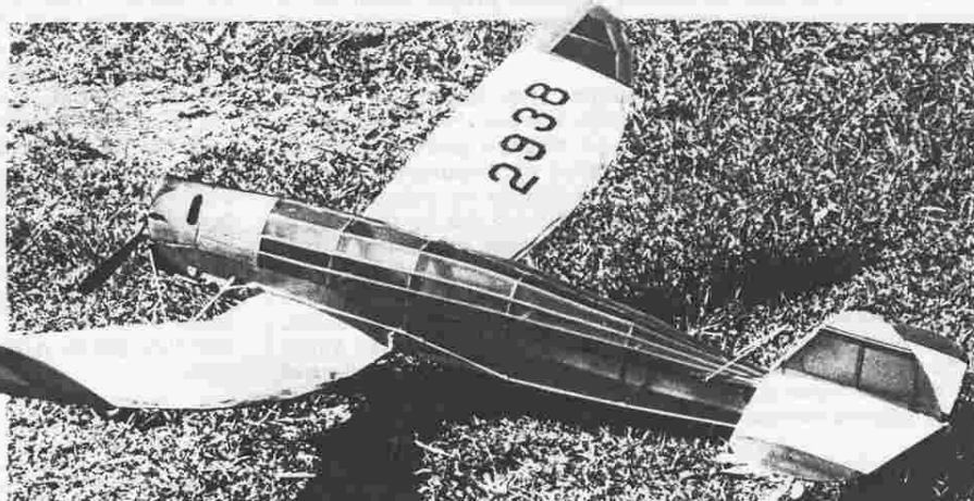
Jako pozdrav do roku 2000 posílá všem členům SAM 95 A. B. Abell z daleké Austrálie fotku svého motorového dolnoplošníku „Peacemaker“. Všimněte si šňůrky na levém boku trupu. Jde od časovače k uvolnění kormidel pro D/T. Kormidla vyklopi pomocná guma jdoucí od trupu ke směrovce.
