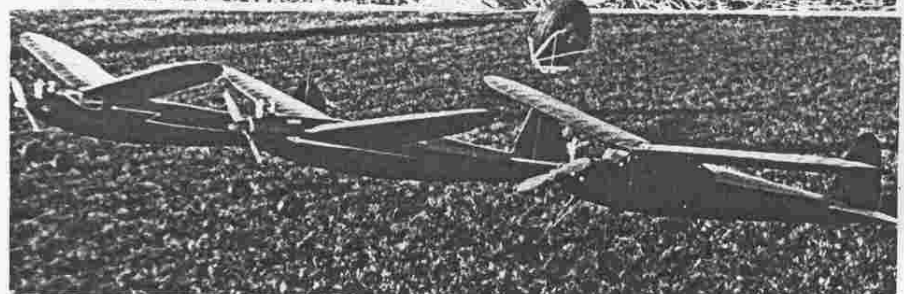
V Kamenných Žehrovicích se již v roce 1943 létaly volné motoráky. Zleva „AUTOBUS“ M. Čermáka, uprostřed „LIMAU“ Rad. Čížka a vpravo „ČÁP“ Zd. Hokra. Všechny modely byly opatřeny motory Letná 6,3 s indukčním zapalováním.
