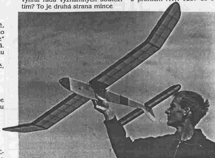
Patnáctiletý Tomáš Plaček si postavil SPARTAK II o celkové ploše 33 dm 2 . Úspěšně s ním zalétal na květnové ARC na kladenském letišti. Model má přijímač REX 4 MICRO, serva JAMARA SUPER MICRO, AKU 650mAh.
