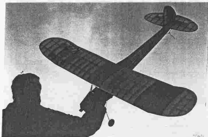
Jako podklad pro svoji elektu použil Vlad. Kostečka z Kam. Žehrovič Čížkův plánek motoráka XL - 43 z roku 1943. Létá motorem Speed 600. Dole je model před potažením.
