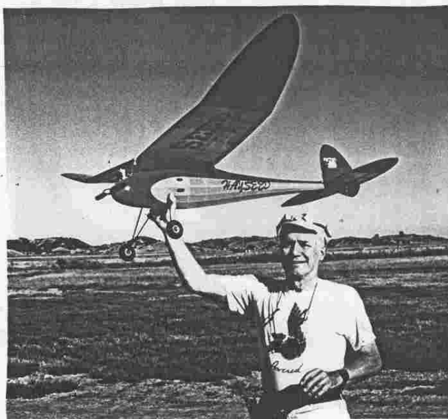
Don Bekins z USA restauroval svůj 12 let starý model Hayseed poháněný motorem Mc Coy 60 (10ccm). Nyní je model potažen novým papírem SAM Span, původně byl potažen hedvábím. Na Šampionátu SAM 1997 v Las Vegas získal s modelem 2. místo.
