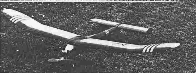
b) Stardust Jardy Macháčka létá velmi spolehlivě. Je poháněn dieslem AMA 2,5. Kdybyste porovnali křídla tohoto modelu, zjistili byste, že jsou to zkrácená křídla z Luňáka.
