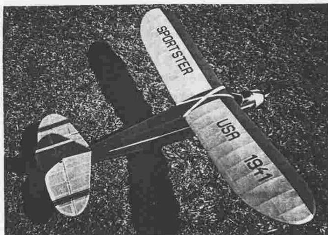
Parádní fotky "na míru" krásného modelu "SPORTSTER" z roku 1941 poslal pňovansky pantáta Mirek KASAL. Několik hlavních dat: Rozpětí 1394mm, délka 1030mm, plocha křídla 30,4 dm 2 , hmotnost včetně Aku 700mAh je 970g. Model je řízen rádiovou soupravou Ranger 3 SE Hitec. El. motor Speed 600. Takových precizních materiálů z našich pastvin bychom potřebovali více.
