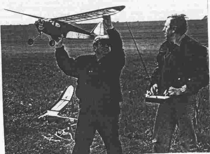
• Jiří BALEJ ze Švermova u Kladna přibyl do rodiny motoráků. Na obrázku vypouští pomocník jeho model "FLY BABY", rozpětí 1840mm, plocha 44 dm<sup>2</sup>, hmotnost 1900g, motor MVVS 3,5, rádio MODELA 6.
