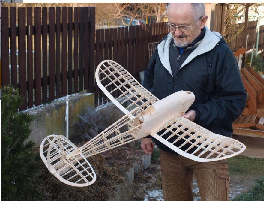
Model Peerless PANTHER, konstrukce Walter Schultz, USA-1940, rozpětí 1 168 mm, staví Václav DAVID dole hotový model při zalétání
