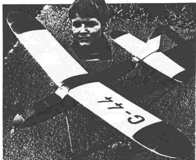
pomoci především. Nebylo to snadné. Na tuto repliku byla z části použita balsa: na žebra křídla i kormidel, odtokovku směrovky a namísto lipových listů  $2 \times 2$  na trup byla použita balsa  $3 \times 3$ , jinak podle originálu. Takovou obměnu materiálu ale stavební pravidla SAM 95 pripouštějí. Jako svazek byla použita asi 10 let stará guma "Pirelli" a sice 5 vláken  $1 \times 4$ . Ano, svazek má na obou koncích oka.
